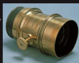
(16) Jozef Maximilián Petzval (1807 - 1891), rodák zo Spišskej Belej, vypočítal v roku 1840 parametre zokonaleného fotografického objektívu, ktorý znamenal revolučnú zmenu vo fotografovaní. Objektív typu Petzval, 60. roky 19. storočia. Slovenské technické múzeum Košice
